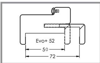
Pour cloison finie de 50 à 72 mm.
